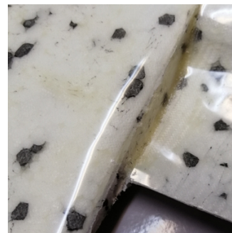
(d) Curved and bend transition in flap area
