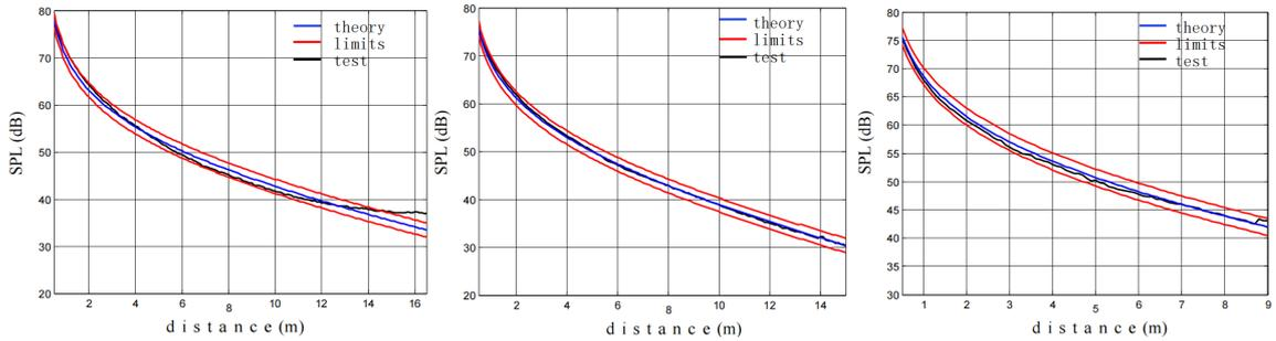
(d) OA path, 40 kHz (e) OB path, 40 kHz (f) OC path, 40 kHz
