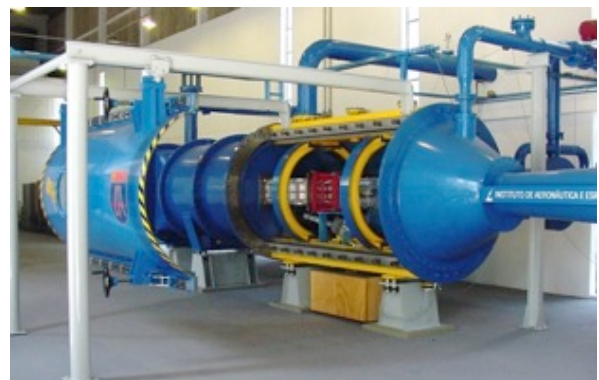
Fig. 3. TTP frontal view with the plenum chamber open.
