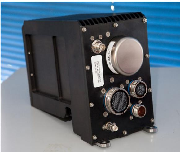
FIG. 1. BAE SYSTEMS AUSTRALIA FLIGHT CONTROL COMPUTER.
