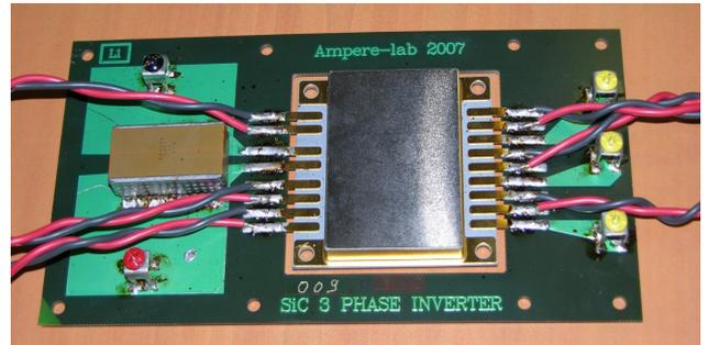
Fig. 16: Power Inverter Module
