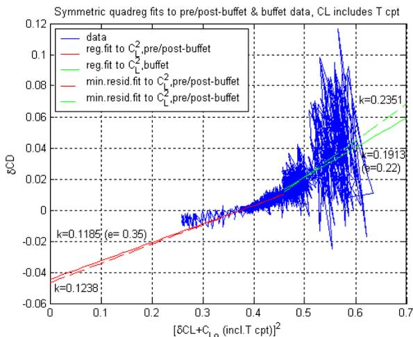
(d)  $C_D$  characteristics with  $\alpha$  and  $C_L^2$
