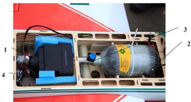
Fig. 6. Onboard PU «CIAM 80-2» UAV
