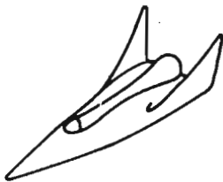
Abb. 3 Wiedereintrittskonfigurationen unterschiedlicher hypersonischer Gleitzahl.
