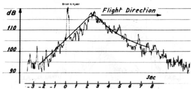
Fig. 6 - Avion en vol - Variation des niveaux sonores mesurés et calculés, rapportés en fonction du temps - Origine du temps : passage à la verticale (niveau global et octaves 63, 250, 1 000, 4 000 Hz).
