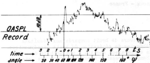
Fig. 2 - Avion en vol - Variation du bruit global au sol
